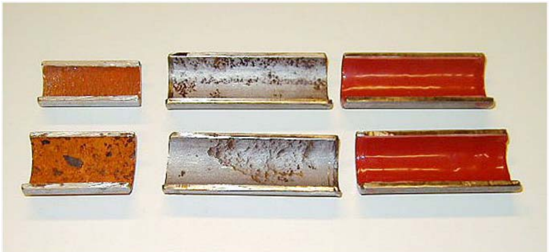
Kuva 6: Putkiston pinnoituksen vaiheet. Kuvassa vasemmalta oikealle kuivattu puhdistamaton putki, puhdistettu putki ja valmis pinnoitettu putki. (Poxytec Oy [verkkodokumentti, viitattu 8.1.2006]).
